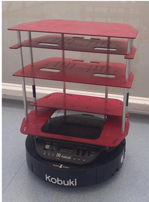
Se debe verificar si el robot está cargado previamente. Para cargarlo se conecta el adaptador con el que viene su alimentación.
